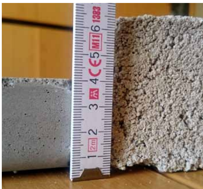
Porovnání hutnosti lité směsi Cemflow (vlevo) a betonové mazaniny
