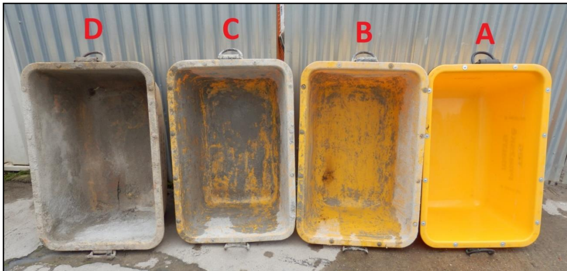
FOTO 1 – Ilustrativní vyobrazení jednotlivých kategorií opotřebení kontejnerů (van).
