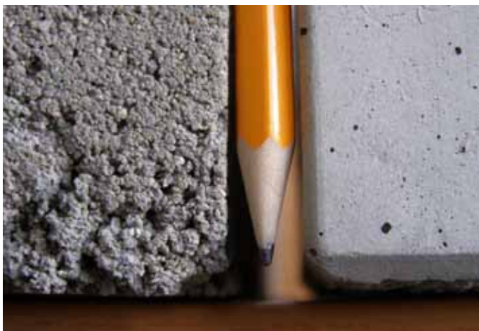
Porovnání hutnosti struktury betonové mazaniny (vlevo) a litého potěru Cemflow (vpravo)
