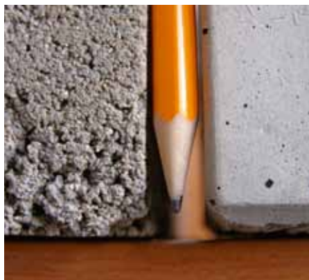
Obr. 1: Srovnání hutnosti zavlhlého a litého potěru
