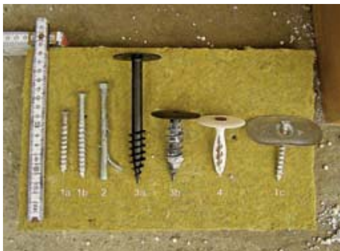
Obr. 10: Testované kotvy po provedení výtažné zkoušky. U Porimentu WS vyhověly kotvy 1b, 2 a 3.
