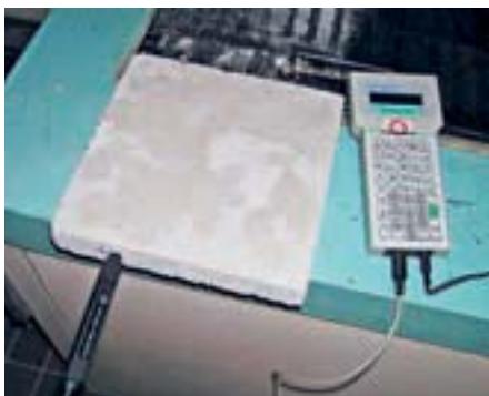
Obr. 7: Měření součinitele tepelné vodivosti na vzorku Porimentu P přístrojem ISOMET 104 s jehlovou sondou
