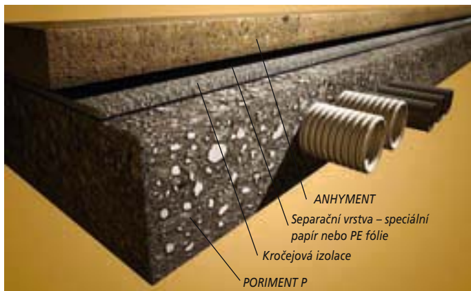
Typická skladba podlahy s materiálem PORIMENT® P
