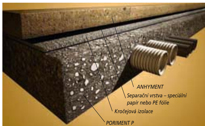
Typická skladba podlahy s materiálem PORIMENT® P
